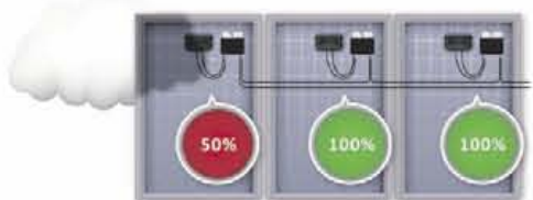
Schaduw effect met een Solaredge omvormer met optimizers
