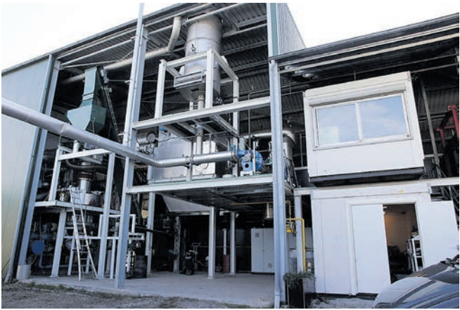
De installatie waar riet via pyrolyse wordt omgezet in brandbare gassen
