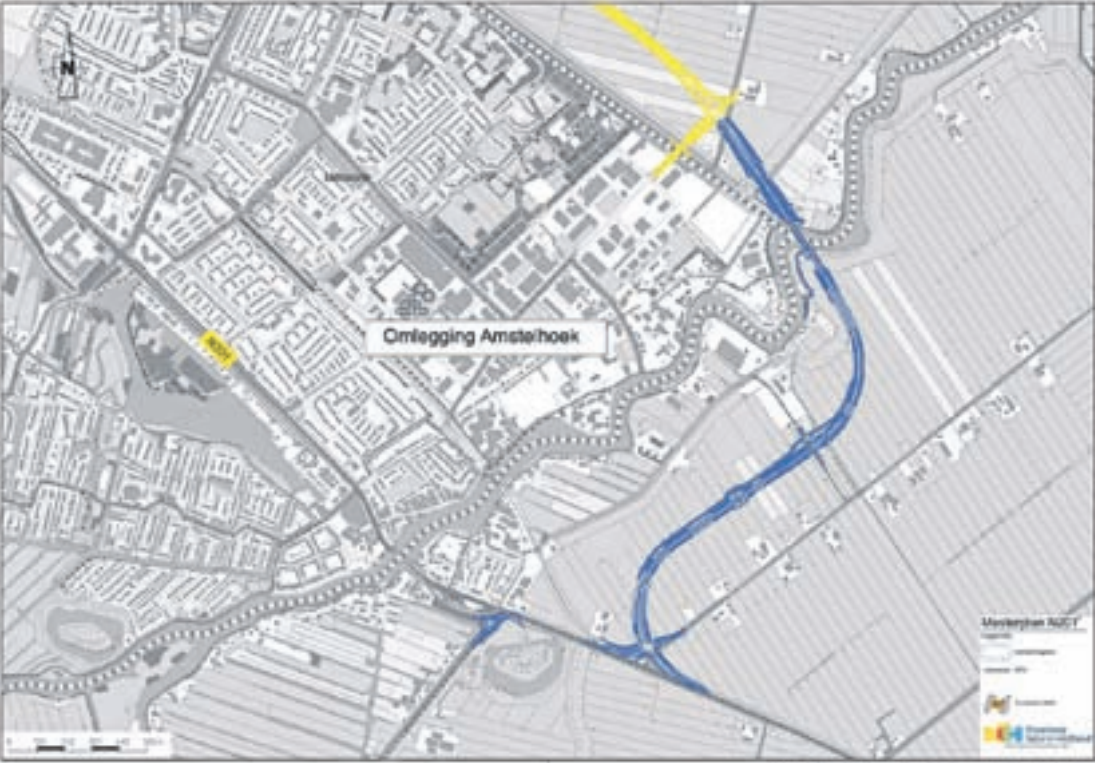
De omlegging van de N201 bij Amstelhoek. Let bij de kruising van de Amstel op de overgang van 2 x 2 rijstroken naar een 2 x 1 rijweg die bij de kruising ter hoogte van de Tienboerenweg weer aantakt op de bestaande N201. Beneden in het midden de contouren van het Fort Amstelhoek
