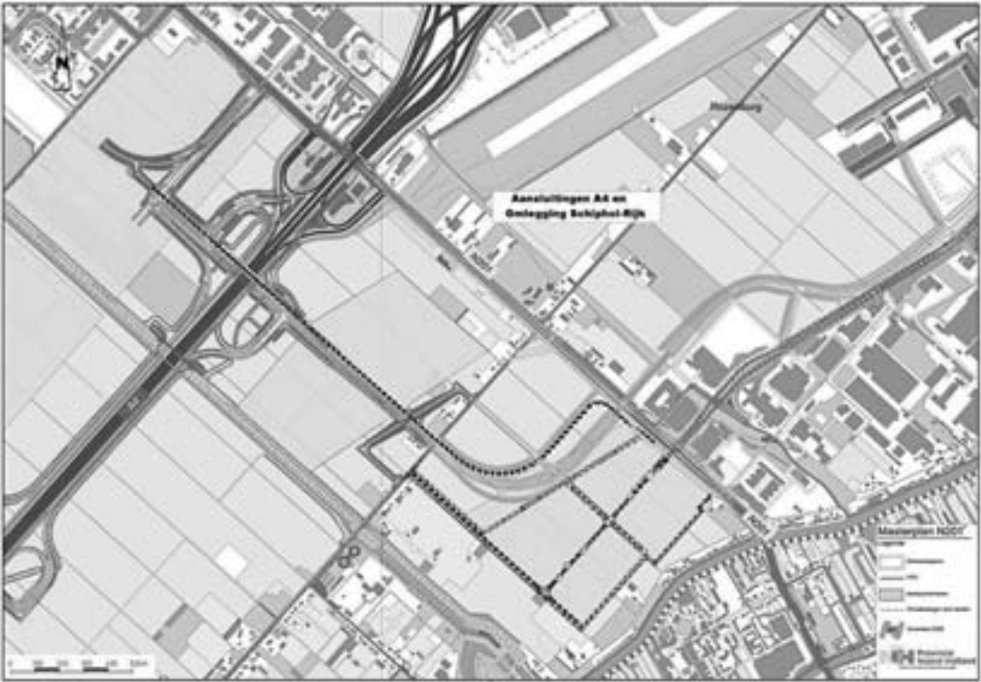
Aansluitingen A4 met links beneden de zuidelijke aansluiting naar Nieuw-Vennep en Hoofddorp-Zuid. Naast ‘A4’ de Geniedijk met de nieuw aan te leggen fietsbrug. Links van het midden de nieuwe aansluitingen voor de N201 die rechts over de bestaande N201 zijn weg vervolgd langs Schiphol-Rijk over het terrein van de luchthaven Schiphol naar de Fokkerweg en Schiphol-Oost (Boerlandvariant)
