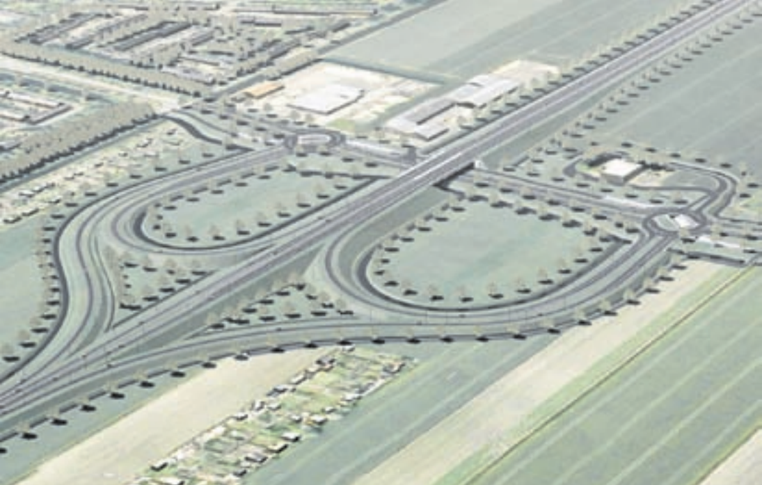
Impressie van de nieuwe ongelijkvloerse kruising bij de Zijdelweg ter hoogte van het Shell tankstation. Rechts van het midden de Zijdelweg richting Amstelveen en links intrede bij de Randweg in Uithoorn. De N201 komt rechtsboven vanuit de richting Aalsmeer en gaat naar Amstelhoek links beneden. Let op de toe- en afritten in de vorm van een half klaverblad
