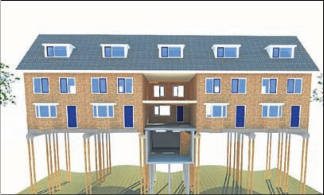
Tussen de fundering realiseert Funderingsherstel Holland een compleet nieuwe ondergrondse woon- of kantoorverdieping
