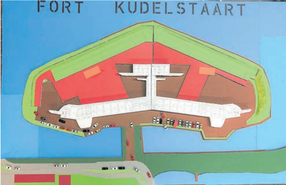
Wanneer het dak van de parkeerkelder is geplaatst worden de twee frontbatterijen misschien weer op het dak geplaatst, dat zijn de oranje vlakjes. Duidelijk te zien is dat de nieuwe kelder het bestaande gebouw raakt, maar er niet onder door gaat, behoudens de horeca aansluiting met de lift. De nieuwe aarden wal bestaat uit een betonconstructie die met groen wordt afgewerkt. Wel zullen er ventilatie mogelijkheden moeten worden opgenomen.
