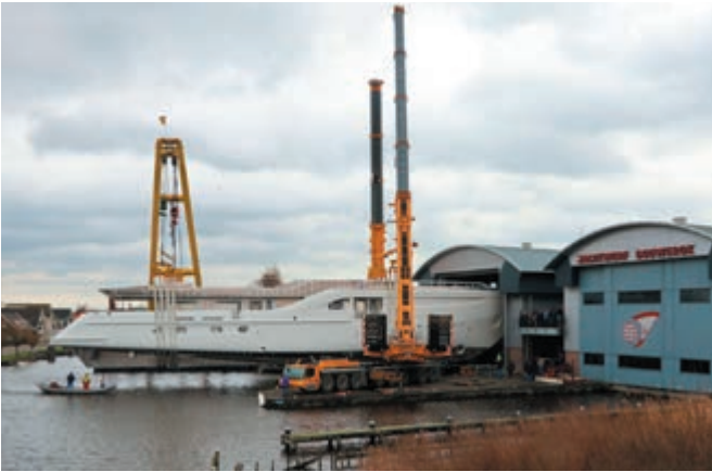
Aalsmeer in volle glorie: een aluminium praam assisteert bij het te water laten van een 56 meter lang casco gebouwd door Jachtwerf Gouwerok voor buurman De Vries Scheepsbouw. Foto: Bert Willems
